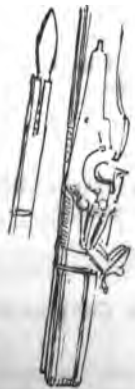
39. Mousquet à rouet, du seizième siècle, se chargeant par la culasse au moyen d'une boîte mobile dite chambre à feu. — Musée de Sigmaringen. Le musée de Dresde possède une semblable arme.
